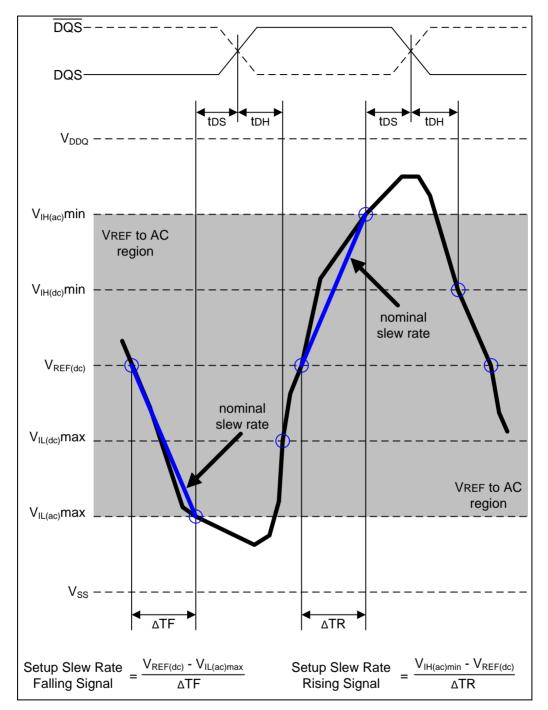
Figure 24 – Illustration of nominal slew rate for tDS (differential DQS, DQS)
