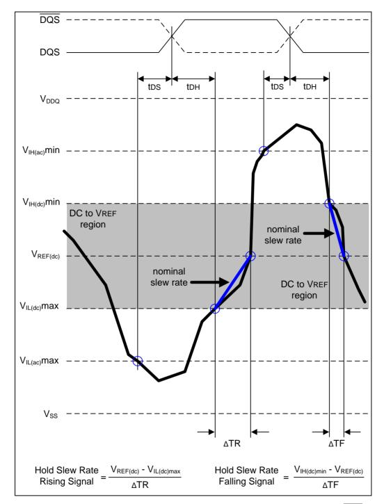
Figure 26 – Illustration of nominal slew rate for tDH (differential DQS, DQS)
