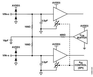
Figure 45. Analog Inputs
