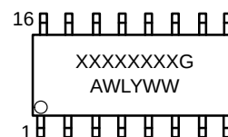
SOIC-16 D SUFFIX CASE 751B
