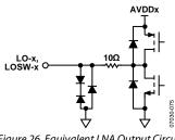
Figure 26. Equivalent LNA Output Circuit
