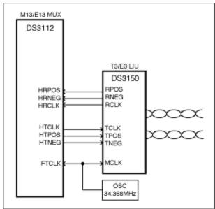
Figure 2. Connections to the DS3/E3 LIU.
