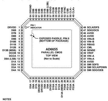
THE EXPOSED THERMAL PAD ON THE BOTTOM OF THE PACKAGE PROVIDES THE ANALOG GROUND FOR THE PART. THIS EXPOSED PAD MUST BE CONNECTED TO GROUND FOR PROPER OPERATION.
