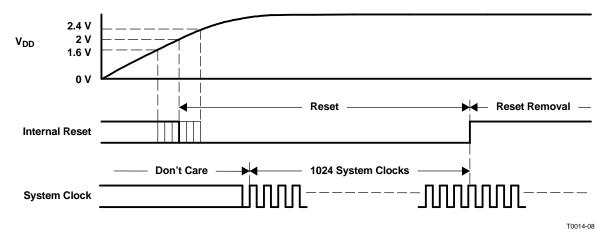
Figure 20. Power-On-Reset Timing
