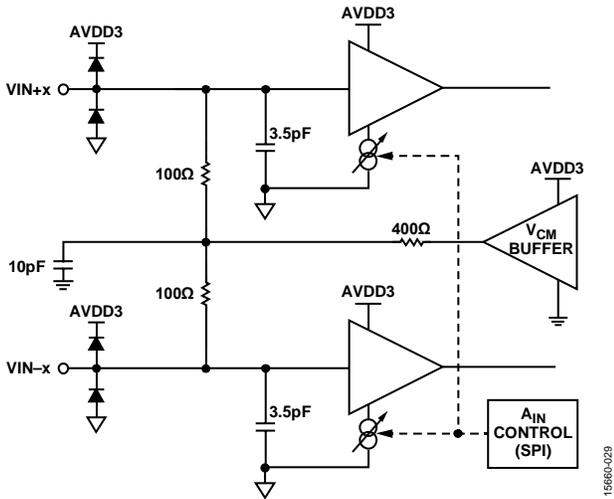
Figure 57. Analog Inputs
