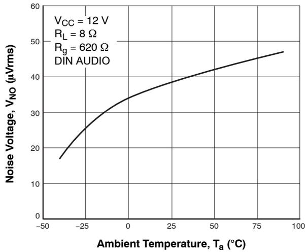
Figure 45.  $V_{NO} - T_a$
