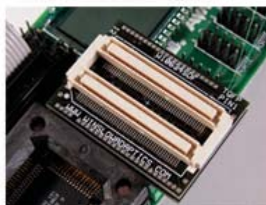
2) Place the top module onto the bottom module
