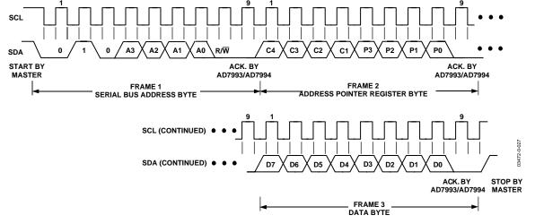
Figure 27. Single-Byte Write Sequence
