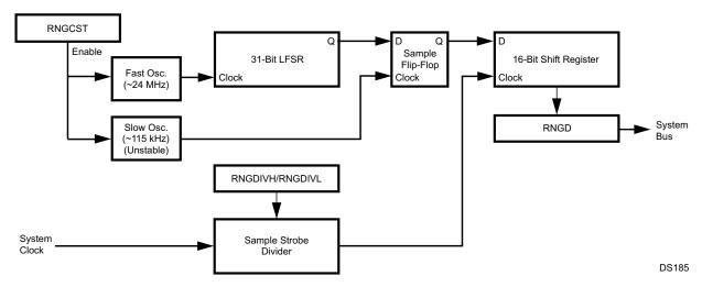
Figure 17-1. RNG Module Block Diagram
