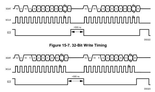
Figure 15-8. 32-Bit Read Timing
