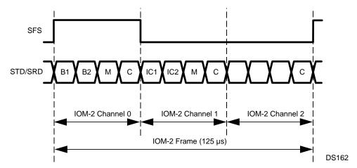
Figure 20-9. IOM-2 Frame Structure
