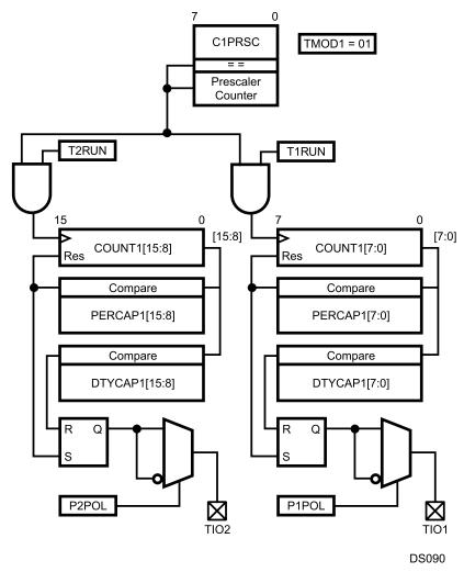
Figure 27-3. VTU Dual 8-Bit PWM Mode
