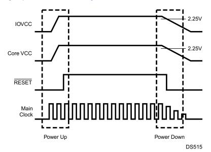
Figure 11-4. Power-On Reset Timing
