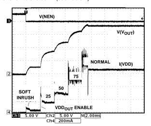
FIGURE 14. FAULT CONTROL SEQUENCE
