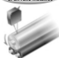
Rilevamento eccentricità di un rullo metallico
