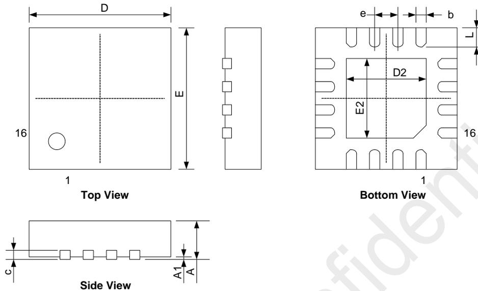
Figure 26. 16-Pin QFN 3x3 Package
