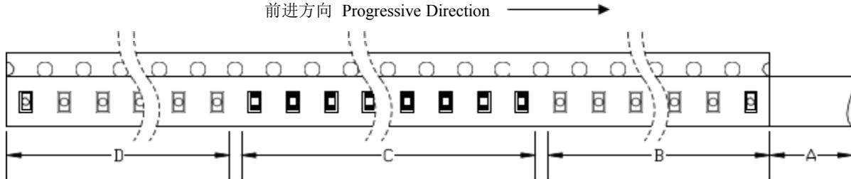
A: 盖带, 300 mm; B: 引导, 空带, 200mm; C: 编载产品 3000 只; D: 尾部, 空带, 200mm
