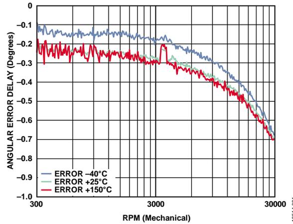
图24. 角度误差延迟与RPM(机械)的关系
