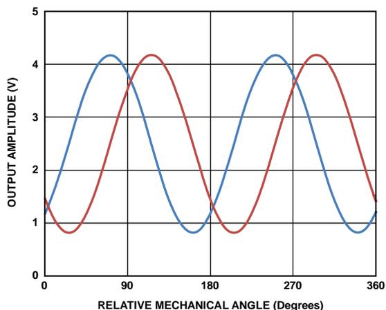
图3. 原始输出波形,  $V_{DD} = 5\text{ V}$ , GC = 开,  $T = 25^\circ\text{C}$
