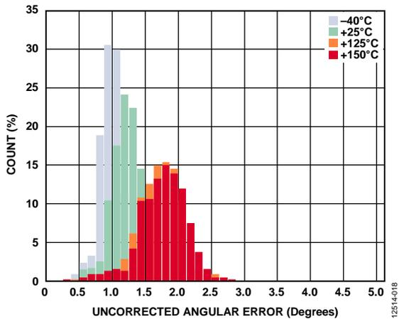
图11. 未校正角度误差,  $V_{DD} = 2.7\text{ V}$ , GC = 开
