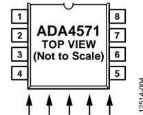
图26. 匀质磁场的方向( $\alpha = 0^\circ$ )
