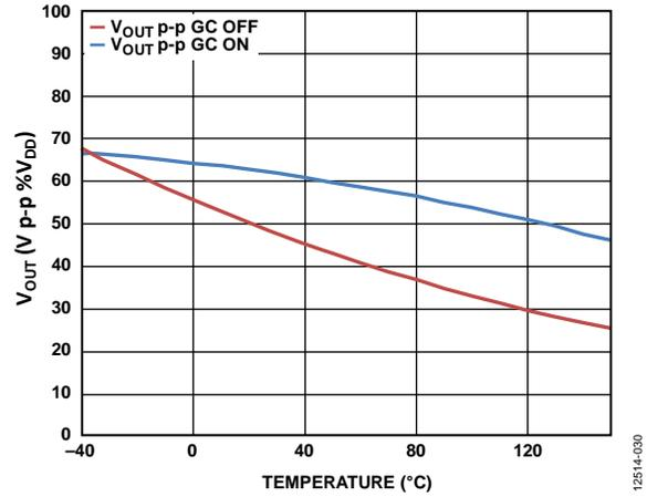
图23. 输出电压( $V_{SIN}$ 和 $V_{COS}$ )峰峰值与温度的关系(%  $V_{DD}$ )
