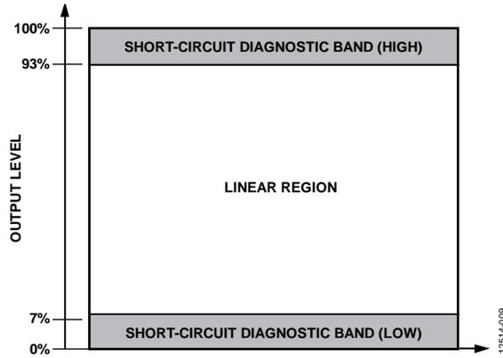
图34. 短路诊断状况中的输出范围分类
