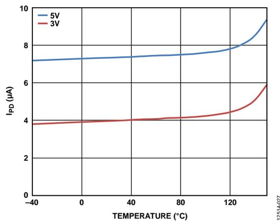
图20. 关断电流( $I_{PD}$ )与温度的关系
