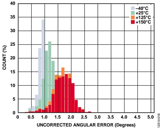
图9. 未校正角度误差,  $V_{DD} = 5.5\text{ V}$ , GC = 开
