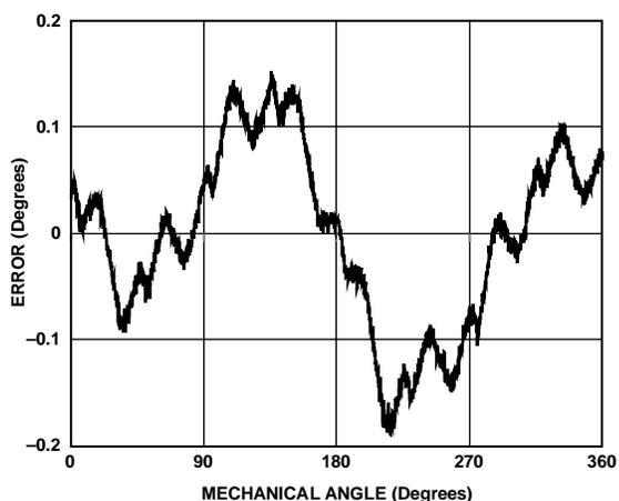
图4. 失调校正后的误差波形,  $V_{DD} = 5\text{ V}$ , GC = 开
