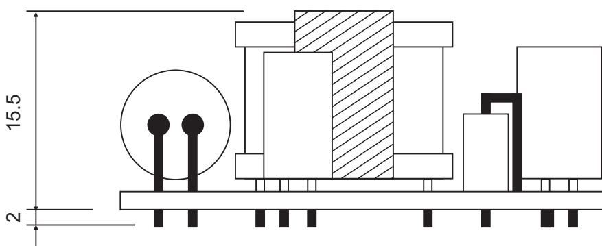
注:此图为PCB导出尺寸,误差为(±1mm)详细尺寸请根据实物为准
