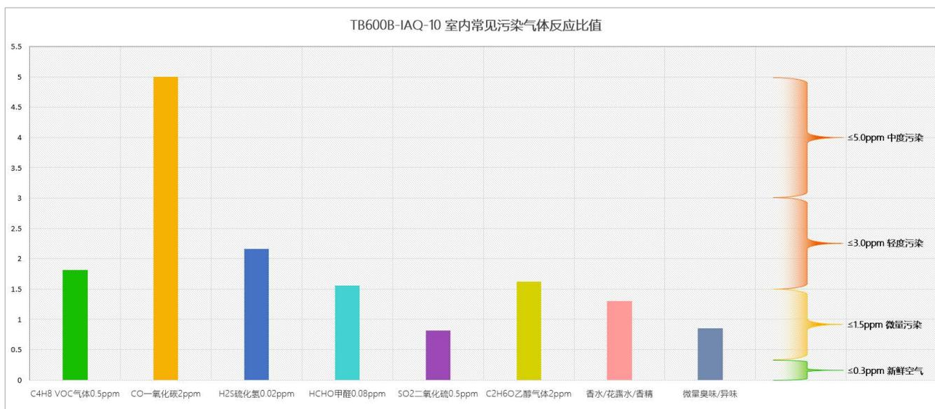
IAQ 空气质量传感器模组对室内主要污染物如: TVOC 气体、甲醛、甲醇、甲苯、二氧化硫 SO<sub>2</sub>、一氧化碳 CO、硫化氢 H<sub>2</sub>S、甲硫醇 CH<sub>4</sub>S、CH 碳氢化合物、SO<sub>x</sub> 硫氧化物等上百种有毒气体有很好的反应特性。
