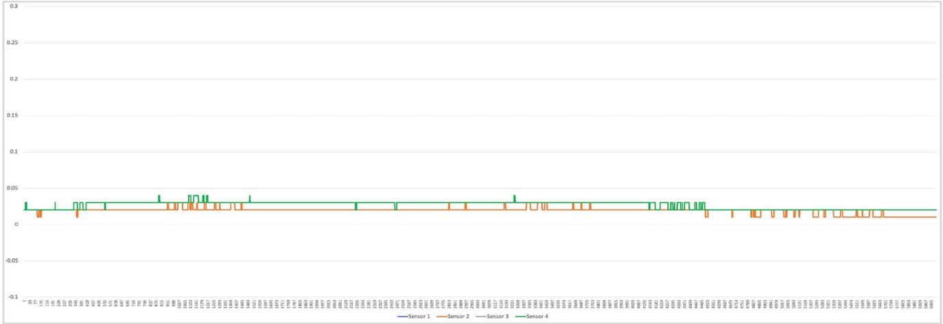
典型测试结果显示: 12 小时洁净空气测试, 零点漂移 <0.05ppm(0-0.2ppm 为正常零点波动范围);
