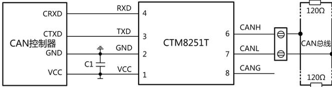
图 1. CAN 控制器 5V 供电应用电路
