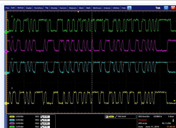
THVD2450 V_{CC} = 3.3V R_L = 50\Omega 50Mbps 速率下的随机 (PRBS7) 数据
