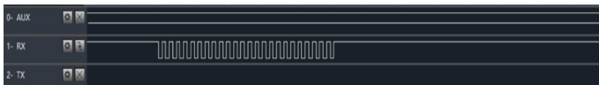
模块接收串口数据时，AUX引脚时序图（连传模式）
