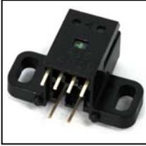
KE-2B10シリーズは、業界で初めての薄さ(h=6.55mm)を実現した「光学式エンコーダ」です。発光素子および受光フォトICに自社製品を採用しており、高品質、経済性を両立させています。分解能は150、180、300、360LPIを取り揃えており、デジタル出力で幅広い用途にご使用いただけます。
