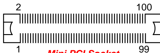
Mini PCI Socket pin orientation
