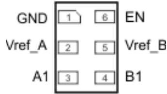
图 5-1. LSF0101 DRY 封装，6 引脚 SON（透明顶视图）
