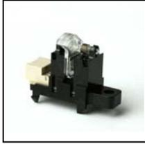
KE401-M120-R1は、接触式Leverの変位量を相対的にEncoderを用いて検出するSensorです。弊社標準のDigital出力Encoder素子を応用する事で分解能10 $\mu$ m以下を低コストで実現しています。また、AD変換が不要な為、回路構成が簡易でノイズ・温度・粉塵等の悪環境下でも性能の変化は僅かです。分解能、検出範囲についてはLever設計により調節が可能です。
