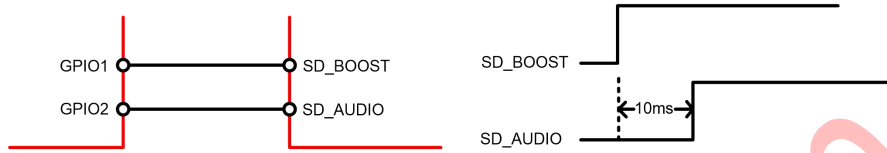
图 1 控制方式一以及上电时序图
