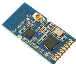
E01-ML01SP2P2 是成都亿佰特设计生产的一款体积小、贴片型、高速率（最高可达 2Mbps）的 2.4GHz 无线模块，SPI 接口，收发一体；模块自带高性能 PCB 板载天线，精确阻抗匹配；也可选择 IPEX 接口使用外置天线。该模块目前已经稳定量产，并适用于多种应用场景。
