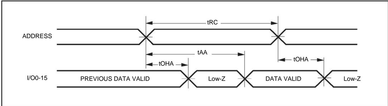
**READ CYCLE NO. 2<sup>(1,3)</sup> ( $\overline{CS1}$ ,  $CS2$  &  $\overline{OE}$  CONTROLLED)**
