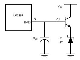
Figure 34. External 3.7V Soft-Start Clamp
