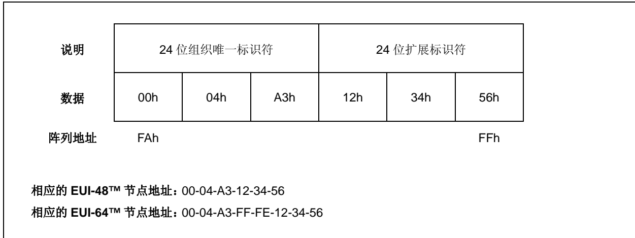
图 9-2: EUI-48 节点地址物理存储器映射示例
