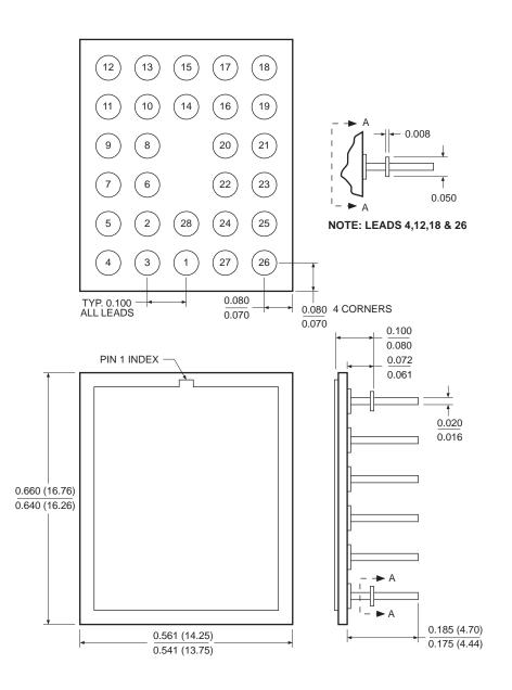
28-LEAD CERAMIC PIN GRID ARRAY PACKAGE TYPE K
