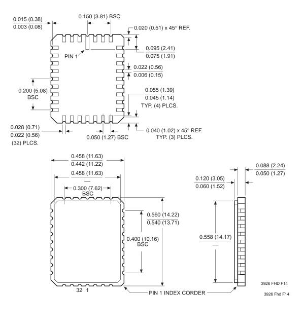
32-PAD CERAMIC LEADLESS CHIP CARRIER PACKAGE TYPE E
