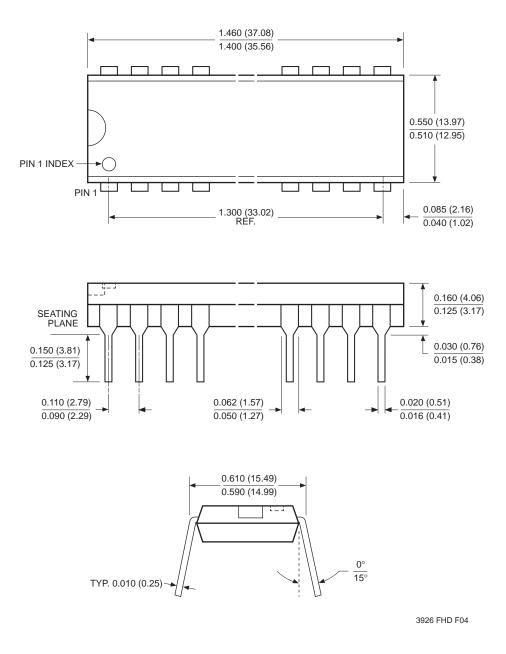
28-LEAD PLASTIC DUAL IN-LINE PACKAGE TYPE P
