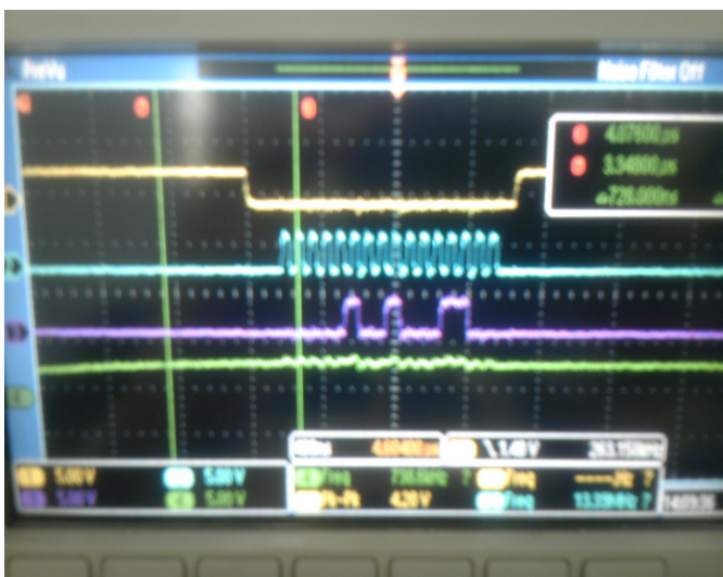
图 4-1. spi_byte_write_espslave 写入 ESP8266 从机波形
