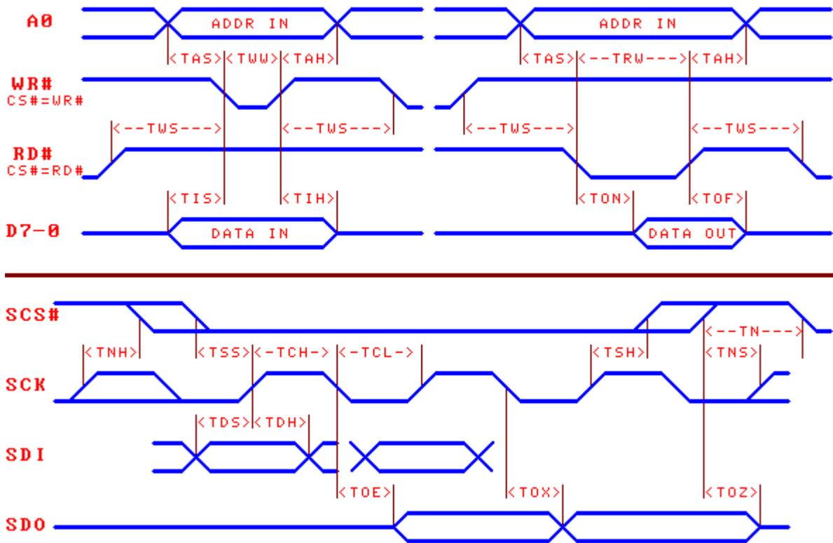
7.5. SPI 串口时序（测试条件：TA=25℃，VCC=5V，括号中参数 VCC=3.3V，参考上面附图）
