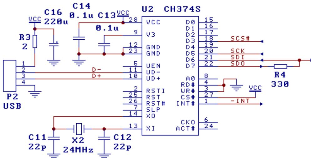
如果 CH374 芯片的 RD#引脚和 WR#引脚为低电平（接地）并且 CS#引脚为高电平（接正电源），那么 CH374 将工作于 SPI 串口方式。在 SPI 串口方式下，CH374 只需要与单片机/DSP/MCU 连接 5 个信号线：SCS#引脚、SCK 引脚、SDI 引脚和 SDO 引脚以及 INT#引脚，其它引脚都可以悬空。
