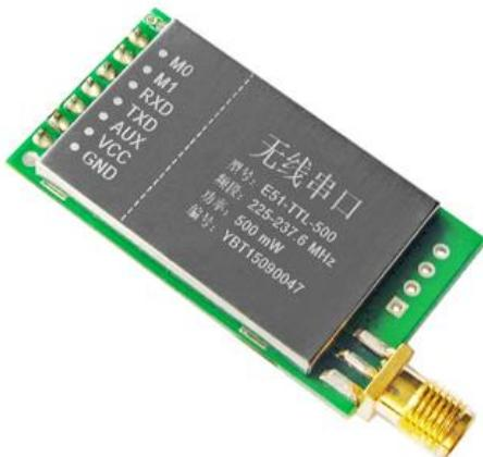
E51-TTL-500 是一款 230M 直插型无线串口模块( UART )，半双工，收发一体，透明传输方式，发射功率 500mW，工作在 225~237.6MHz 电力频段（默认 230MHz），TTL 电平输出，兼容 3.3V 与 5V 的 IO 口电压，具有空中唤醒功能( 超低功耗 )。
