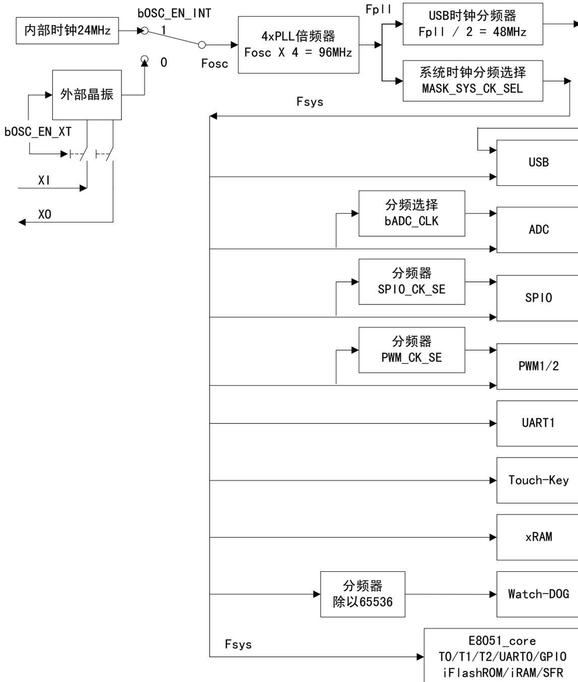
内部时钟或者外部时钟经过二选一后作为原始时钟  $F_{osc}$ ，再经过  $4 \times PLL$  倍频后产生  $F_{pll}$  高频时钟，最后经过两组分频器分别得到系统时钟  $F_{sys}$  和 USB 模块的时钟  $F_{usb4x}$ 。系统时钟  $F_{sys}$  直接提供给 CH552 的各个模块。
