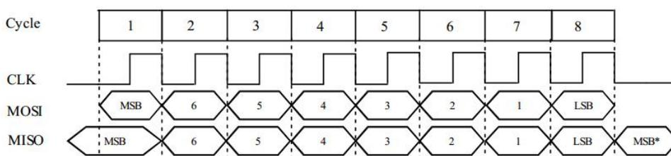
图 14.3.1 SPI 模式 0 时序图
