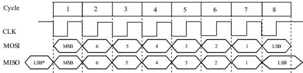
图 14.3.2 SPI 模式 3 时序图
