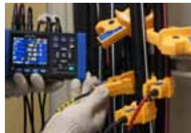
Messort ohne spannungsführenden Teile ⇓ an der Kabel- isolierung messen
