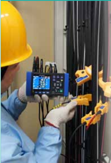
Messort ohne spannungsführenden Teile ⇓ an der Kabel- isolierung messen
