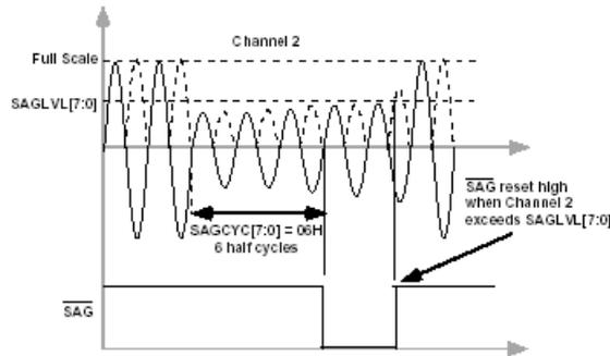
如上图所示，当电压有效值小于跌落电压阈值寄存器（SAGLVL）中设定的阈值并且跌落时间超过跌落线周期寄存器（SAGCYC）中的设定时间（图示为超过第 6 个半周期后，SAGCYC[7:0]=06H），线电压跌落事件通过设置中断状态寄存器中的 SAG 标志位来记录下来。如果中断屏蔽寄存器（MASK）中相应的 SAG 使能位置为逻辑 1，则/IRQ 逻辑输出变为有效低电平。
