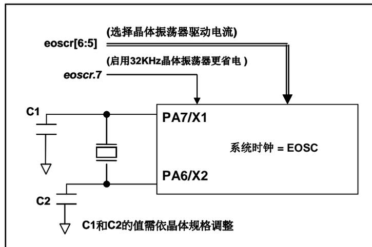
图 8: 晶体振荡器的硬件连接
