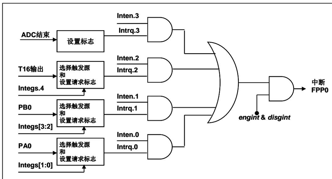
图 12: 中断硬件框图
