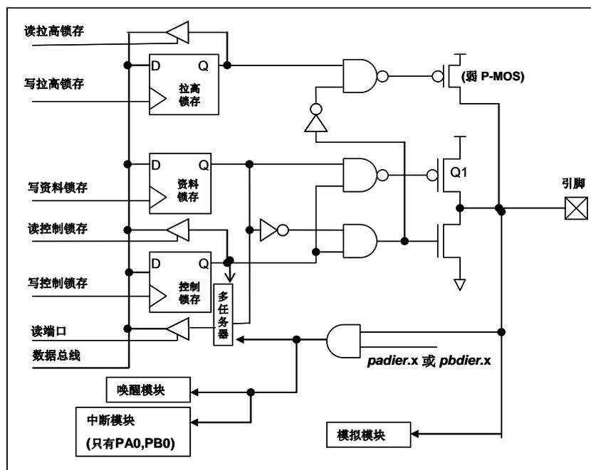
图 16: 引脚缓冲区硬件图
