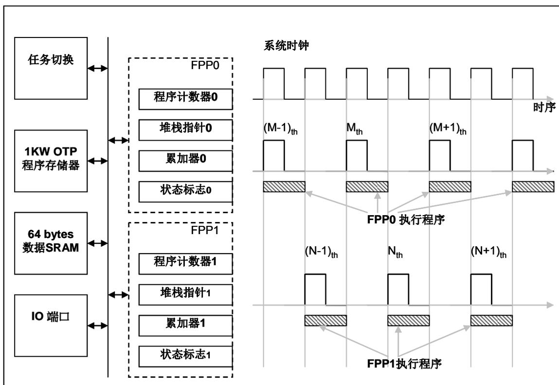
图 1：硬件 FPP 内部硬件和时序图
