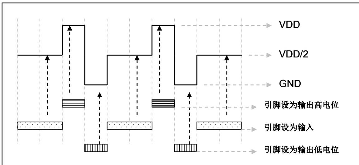
图 17: 使用半电位偏置电压
