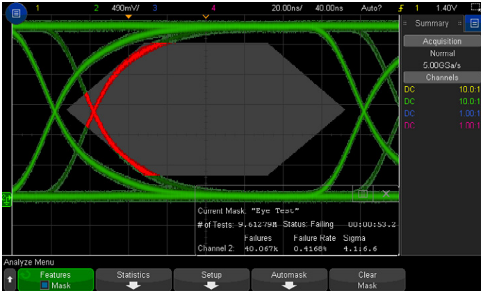
그림 28: 하드웨어 가속 마스크 테스트는 golden 파형이나 사용자 생성 마스크를 테스트하여 위반 조건을 찾아냅니다. 위의 예에서는 불과 30초 만에 500만 건의 테스트를 캡처했습니다.
