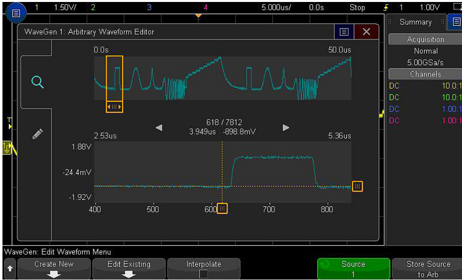
그림 25: 임의 파형 발생기 옵션을 이용하면 자극 출력이 손쉽게 액세스할 수 있습니다. 통합 임의 파형 발생기는 신호의 캡처, 수정 및 재현을 손쉽게 수행할 수 있습니다.
