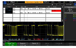
그림 17: CAN-FD 디코더 및 트리거
