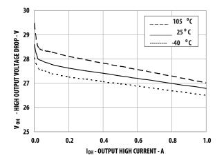
Figure 6. V<sub>OH</sub> vs. I<sub>OH</sub>
