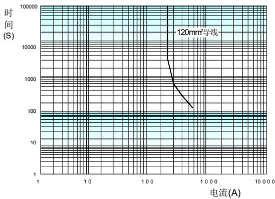
备注: 以上数据在常温下测得, 仅作参考, 请勿直接用于选择熔断器。
