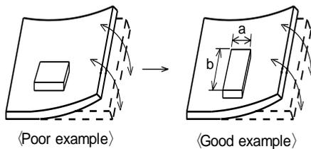
ストレスの作用する方向に対して、横向き(長さ:a<b)に部品を配置して下さい。
