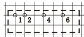
俯視圖, 柵格間距 2.54mm 開孔直徑 1.00mm
