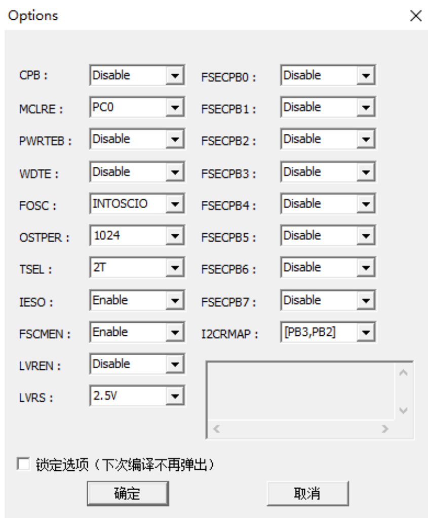
图 22-1 由 IDE 设置的初始化配置寄存器
