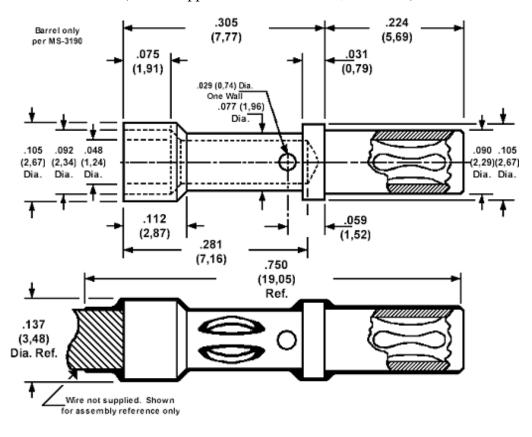
Min hole depth (socket) .185 (4,70)
