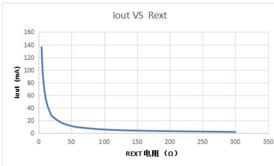
输出电流与 REXT 电阻关系曲线（测试条件：V OUT-GND =30V）
