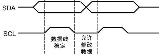
图 16-6. I 2 C 总线位传输过程中的数据有效性
