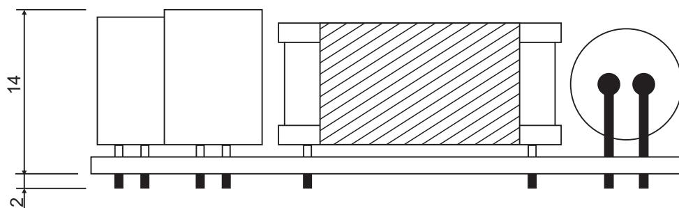
注: 此图为PCB导出尺寸, 误差为( $\pm 1\text{mm}$ )详细尺寸请根据实物为准
