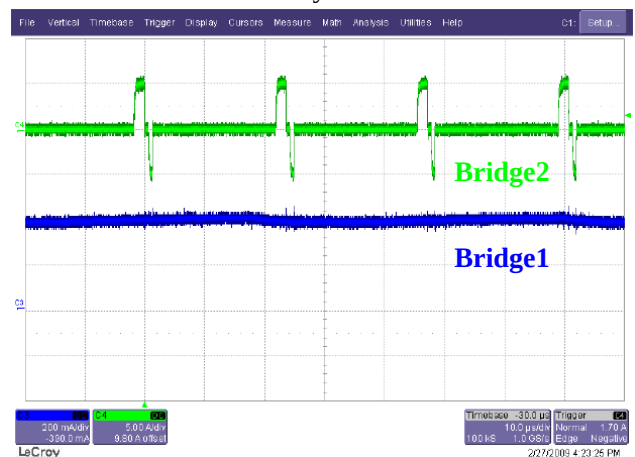
Out-Out ショート時における電流の挙動 (Bridge2 の出力をショート) Slow Decay
